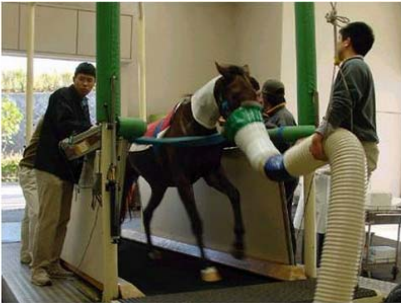
写真1 馬用トレッドミルによる最大酸素摂取量測定風景
