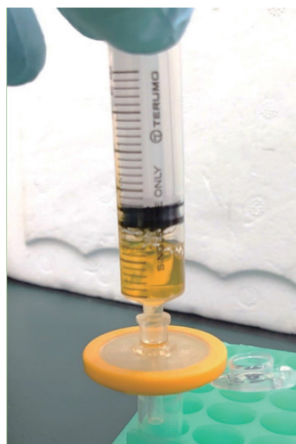
＜写真1＞ PRP作製時は感染リスクを下げるためにフィルター等を利用して滅菌処理を実施します。
