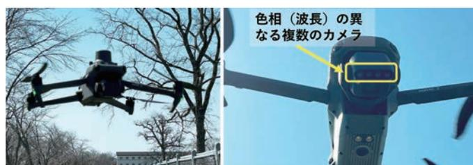
図3 マルチスペクトルカメラ搭載ドローン
