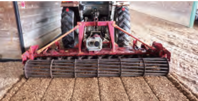
写真2 パワーハローによる上層の攪拌 爪で上層の15cmをかき混ぜ、ドラムで均します。
