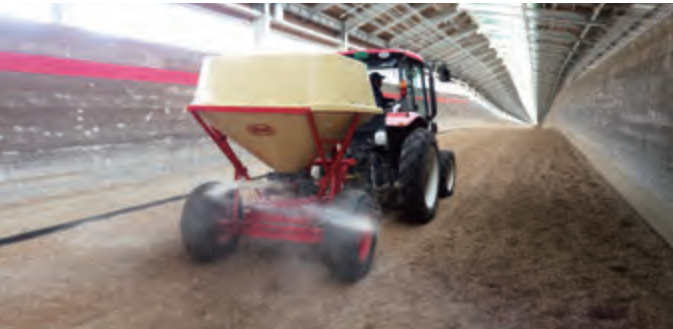
写真1 ブロードキャスターによる散布 最大1t積載が可能で、馬場の水分状態に合わせ、回転数や振れ幅を調整しながら散布します。
