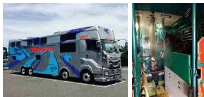
図2 馬運車内での超音波噴霧器による微酸性次亜塩素酸水の噴霧 競走馬用の馬運車に設置した結果、輸送熱が減少しています。 (写真は、株式会社丸昇八田(札幌市)提供)
